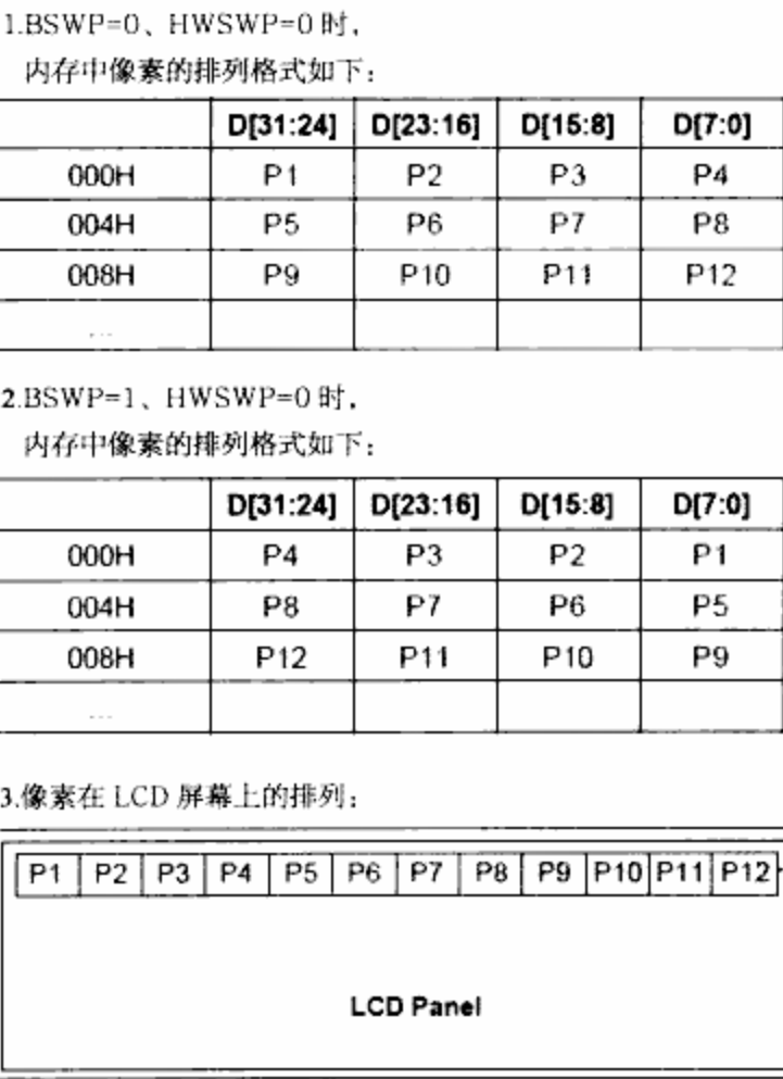
图 13.6 8BPP 模式下内存数据与像素位置对应关系
