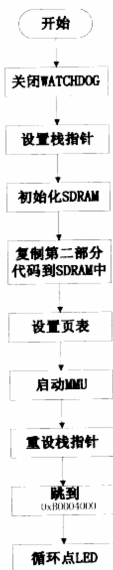
图 7.15 MMU 实例程序流程
